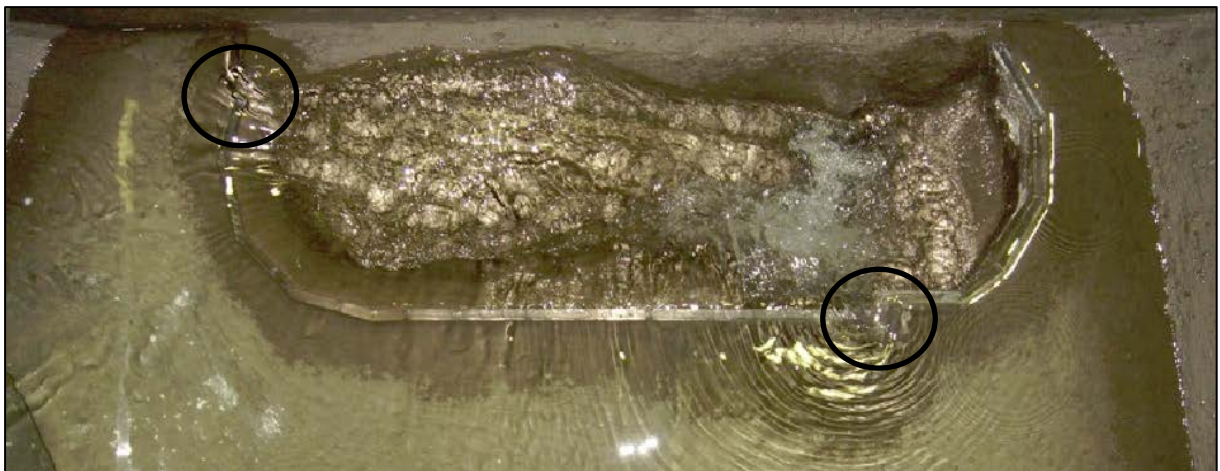
Figur 73 Vannspeil Q lik 93 \text{ m}^3/\text{s} modellforsøk (Røneid & Sæter, 2007) Svart sirkel: singulærpunkt.
