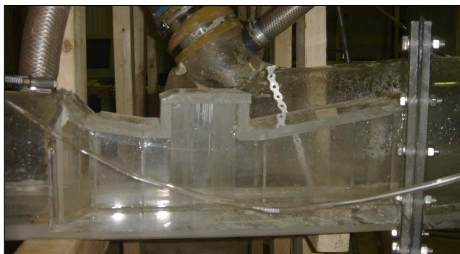
Figur 13 Omløpstunnel (Røneid & Sæter, 2007)(nærmest kamerat)
