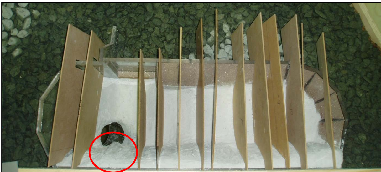
Figur 26 Terreng under bygging (Røneid & Sæter, 2007) Rød sirkel: kul over sjakt
