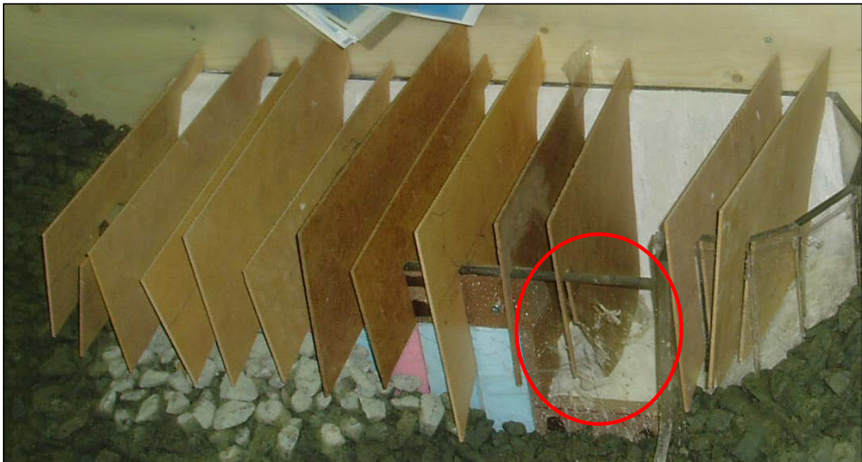
Figur 28 Profiler samlekanal (Røneid & Sæter, 2007) Rød sirkel: avvik profil 3 fra høyre
